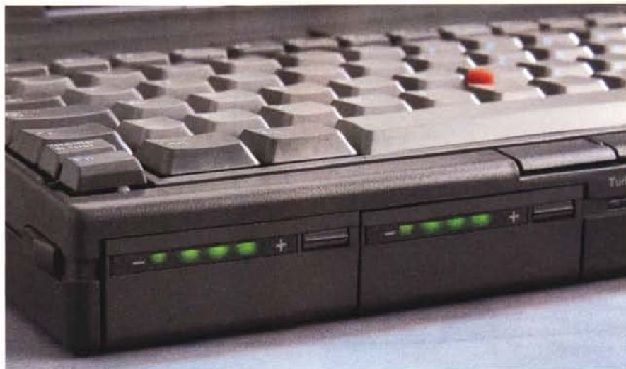
A fianco particolare dello slider della luminosità. Le batterie riservano una vera novità: una piccola scala a led che indica anche con la batteria estratta la quantità di carica.
